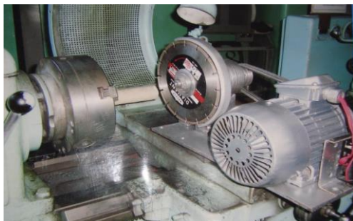
Рисунок 5 – Технологический модуль с дисковым алмазным инструментом
